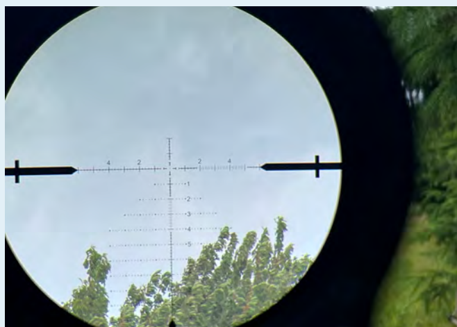
Hårkorsikte användbart system för att bedöma avstånd och att hålla upp för höjd och vind.
