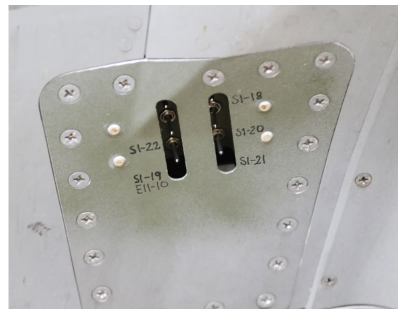
Dolt under vingen på ett av SK60-planen har lärarna byggt in en kontrollpanel med fel som kan kopplas på och av med en knapptryckning.
